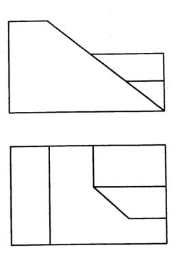
C2.- Representar y acotar en diédrico, a escala E1:1, la pieza adjunta, dando las vistas, cortes y/o secciones que se consideren necesarios. Los cuatro agujeros son pasantes, Cy = 1, y el diámetro mayor es de 60 mm.
