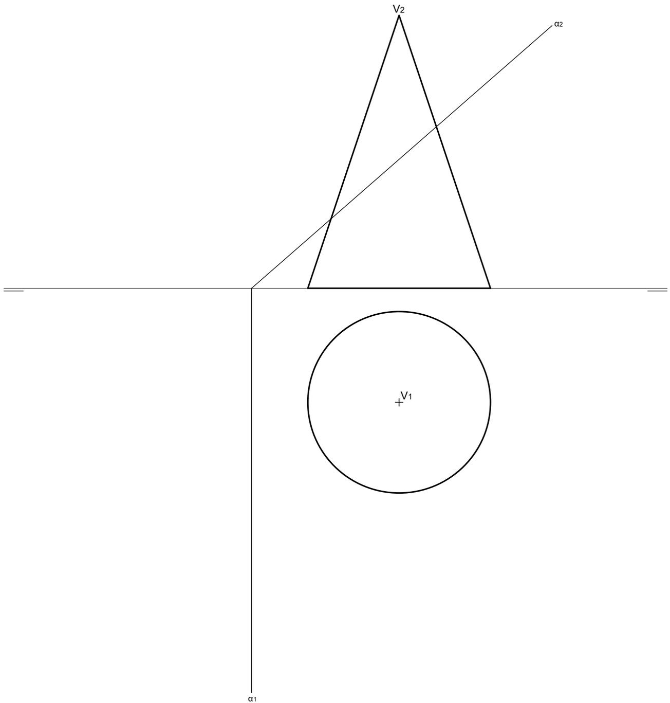
1. Hallar la sección producida en el cono por el plano  $\alpha$ , asv como los puntos de tangencia de la sección con las generatrices del contorno aparente de la proyección vertical del cilindro.
