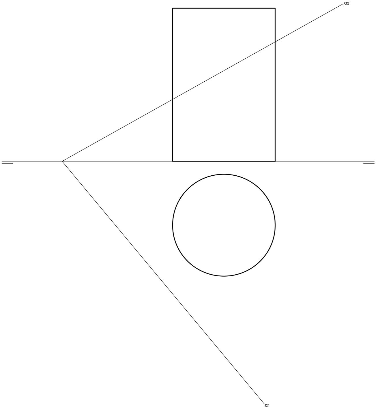
1. Hallar la sección producida en el cilindro por el plano  $\alpha$ , asv como los puntos de tangencia de la sección con las generatrices del contorno aparente de la proyección vertical del cilindro.
