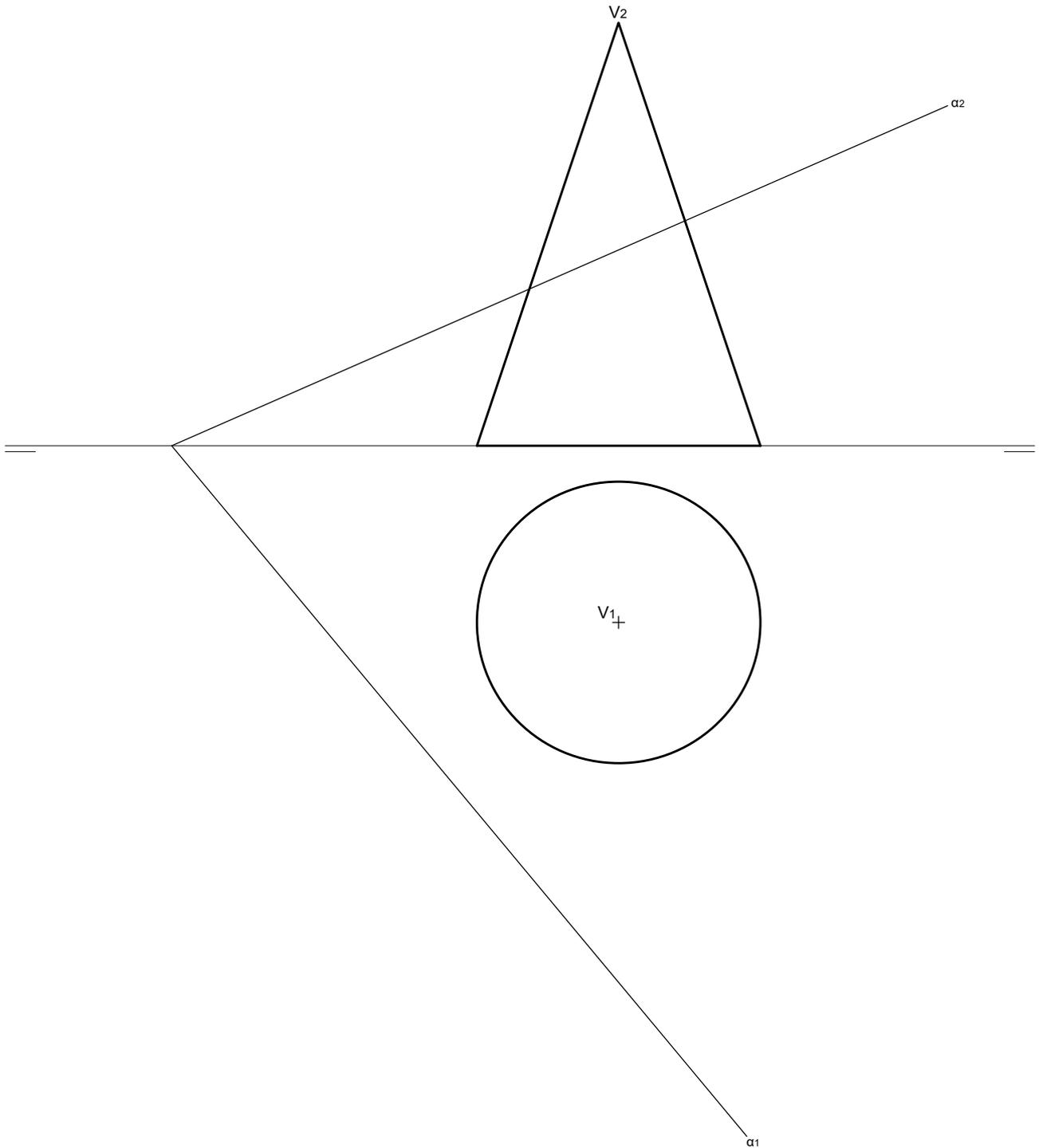
1. Hallar la sección producida en el cono por el plano  $\alpha$ , así como los puntos de tangencia de la sección con las generatrices del contorno aparente de la proyección vertical del cilindro.
