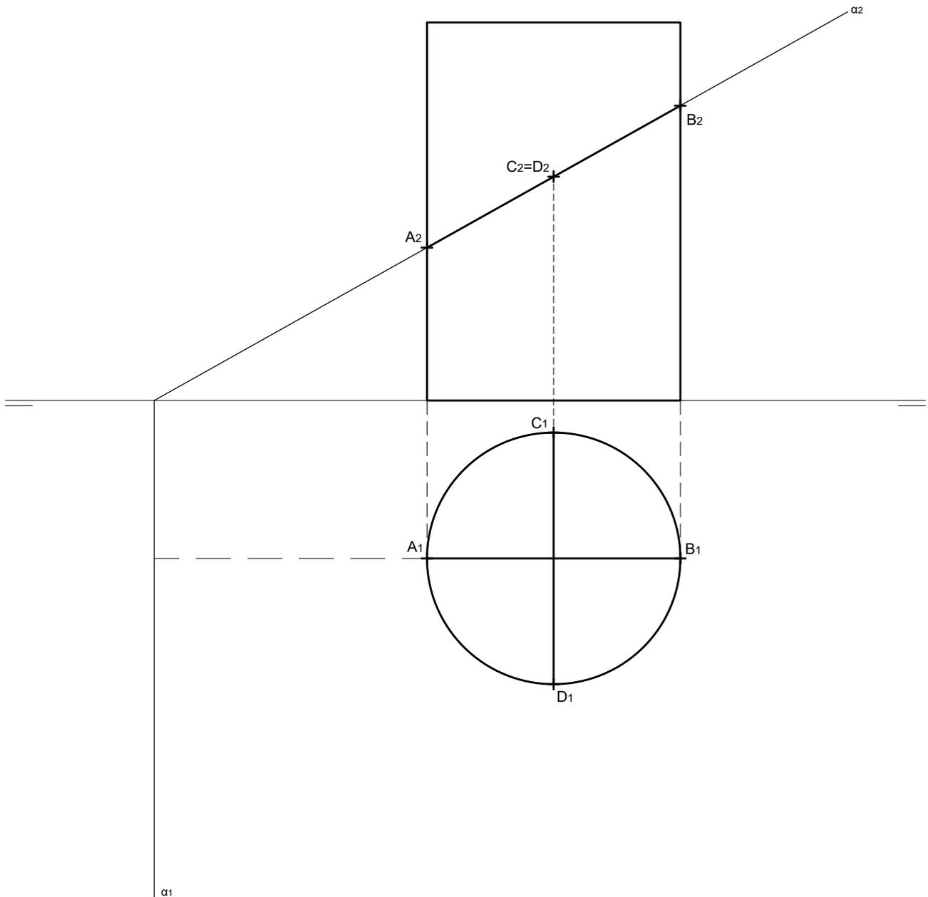
1. Hallar la sección producida en el cilindro por el plano  $\alpha$ , así como los puntos de tangencia de la sección con las generatrices del contorno aparente de la proyección vertical del cilindro.
