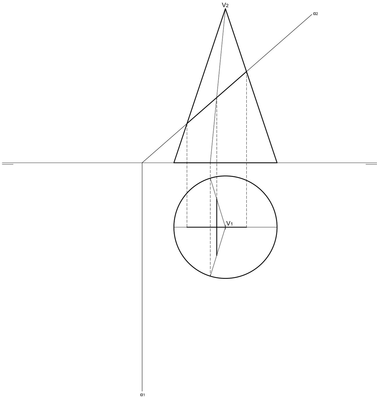
1. Hallar la sección producida en el cono por el plano  $\alpha$ , así como los puntos de tangencia de la sección con las generatrices del contorno aparente de la proyección vertical del cilindro.
