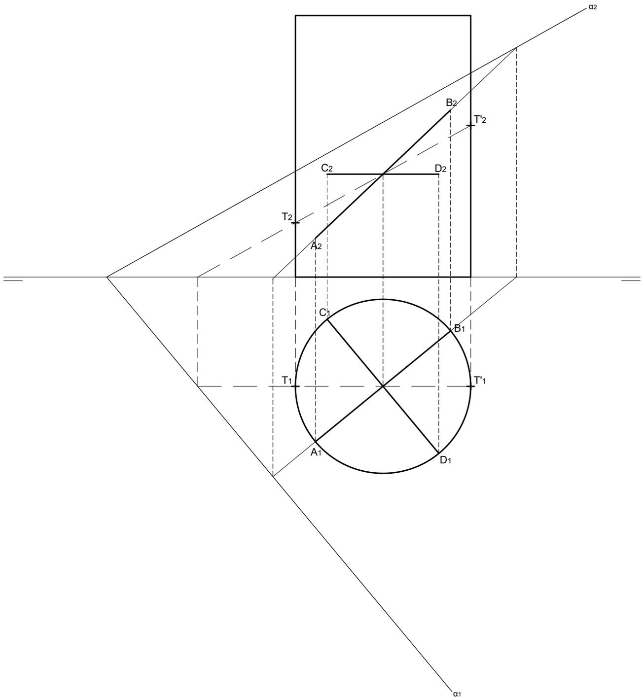
1. Hallar la sección producida en el cono por el plano  $\alpha$ , asv como los puntos de tangencia de la sección con las generatrices del contorno aparente de la proyección vertical del cilindro.
