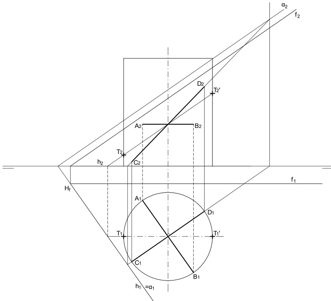
1. El plano que contiene la recta  $r$  y los puntos  $A$  y  $B$  secciona al cilindro recto dado, siendo  $A$  y  $B$  puntos de la cónica intersección. Determinar la sección por sus ejes principales. (*Selectividad, junio 2009*).
