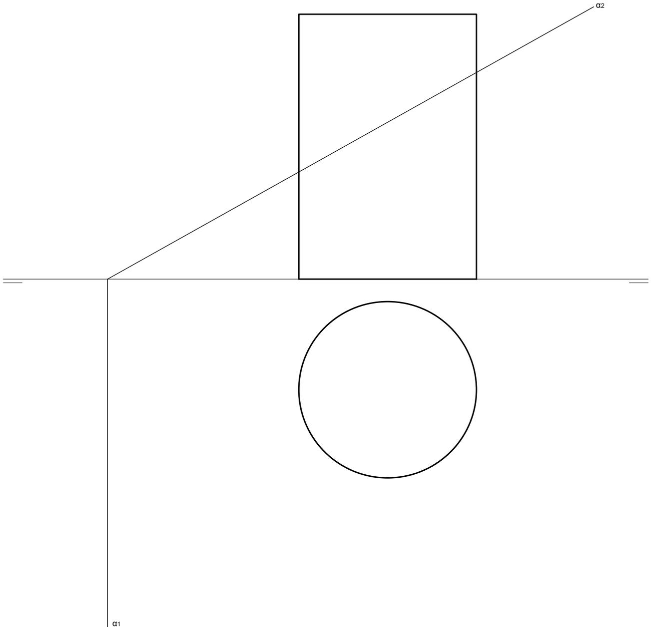
1. Hallar la sección producida en el cilindro por el plano  $\alpha$ .
