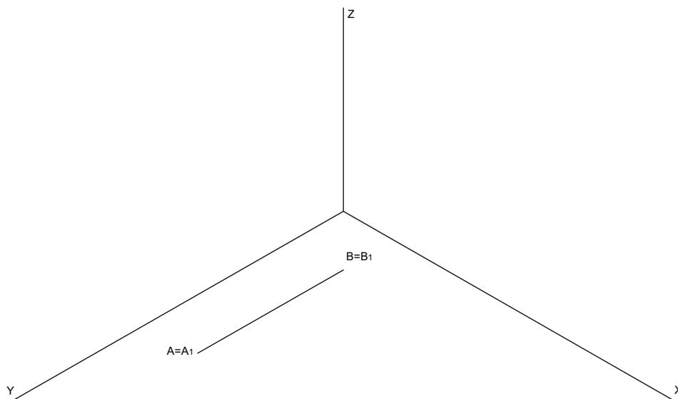
1. El segmento **AB** es un lado de un cubo. Trazar dicho cubo atendiendo a su visibilidad, de modo que quede íntegramente en la parte vista del triedro trirectángulo.
