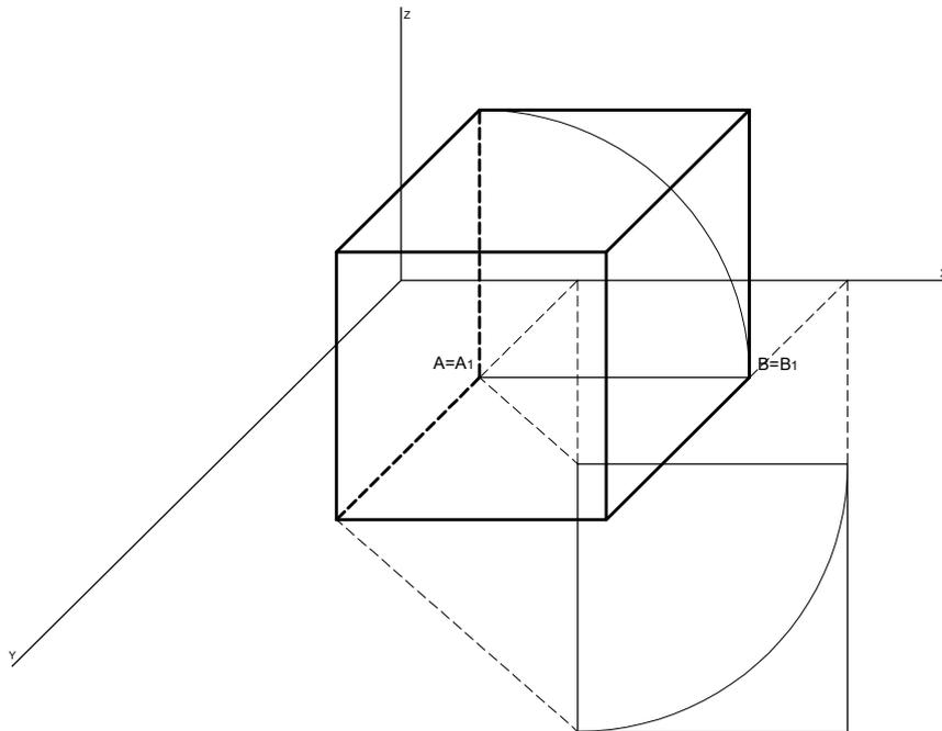
2. Trazar un prisma recto si el segmento  $AB$  es una arista de un triángulo equilátero apoyado en el plano  $xy$  que le sirve de base, siendo su altura de igual magnitud que las aristas de su base. Coeficiente de reducción del eje  $Y$  es  $CY=1/2$
