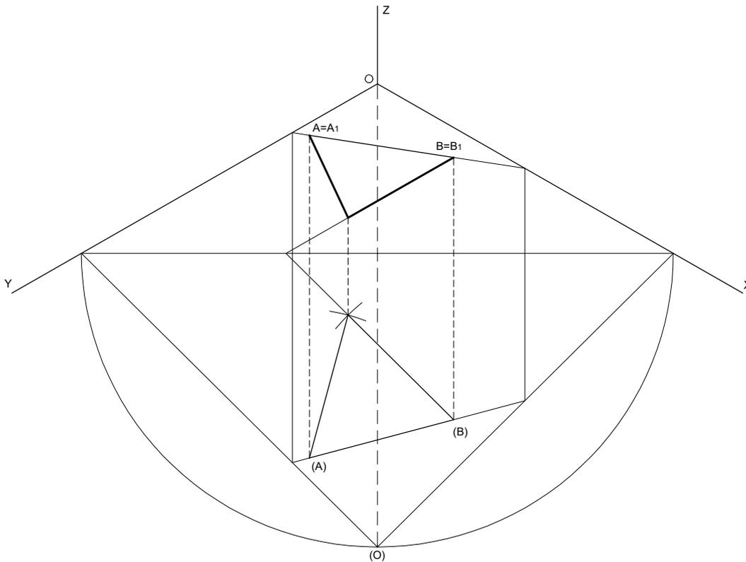
1. El segmento **AB** es un lado de un cubo. Trazar dicho cubo atendiendo a su visibilidad, de modo que quede íntegramente en la parte vista del triedro trirectángulo.
