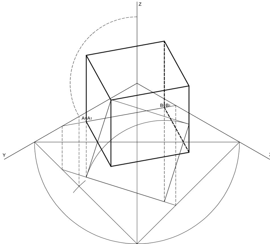
2. El segmento **AB** es un lado de un cubo. Trazar dicho cubo atendiendo a su visibilidad, de modo que quede íntegramente en la parte vista del triedro trirectángulo.
