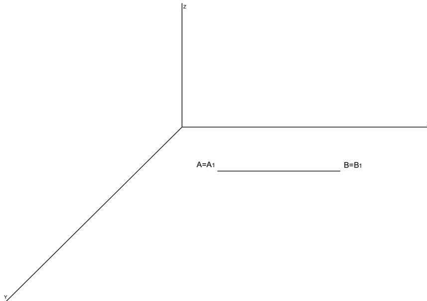
2. Trazar un prisma recto si el segmento **AB** es una arista de un triángulo equilátero apoyado en el plano xy que le sirve de base, siendo su altura de igual magnitud que las aristas de su base. Coeficiente de reducción del eje Y es  $CY=1/2$
