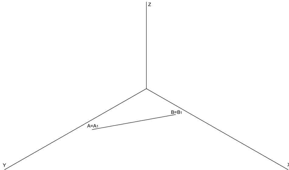
2. El segmento **AB** es un lado de un cubo. Trazar dicho cubo atendiendo a su visibilidad, de modo que quede íntegramente en la parte vista del triedro trirectángulo.
