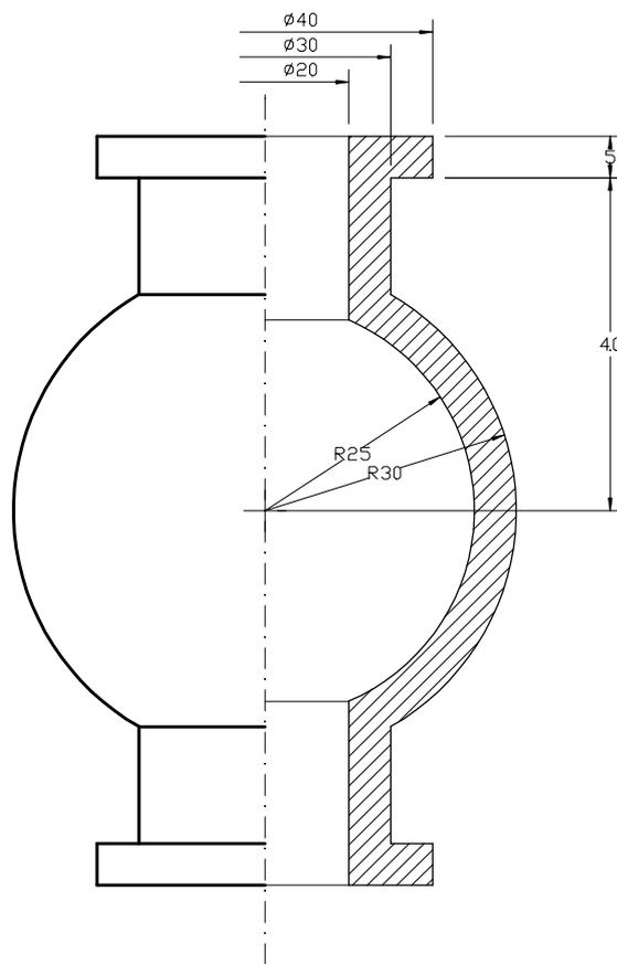
1. Completar la representación de la siguiente pieza de revolución cortada "al cuarto" y acotarla según normas.
