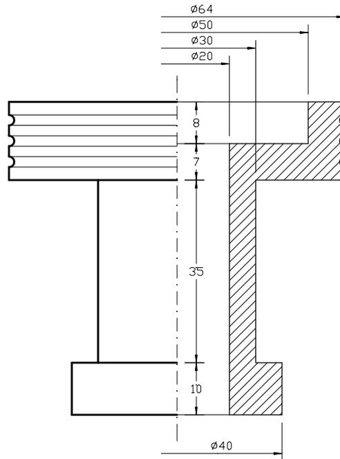
2. Completar la representación de la siguiente pieza de revolución cortada "al cuarto" y acotarla según normas.
