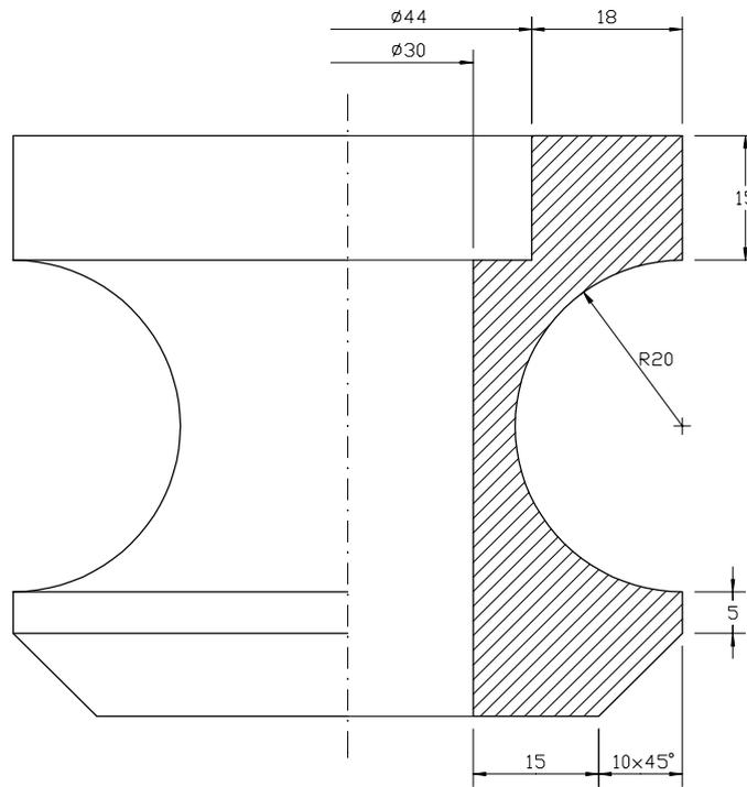
2. Completar la representación de la siguiente pieza de revolución cortada "al cuarto" y acotarla según normas.
